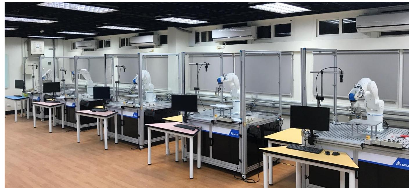
本系提供兩間實驗室約一百五十平方公尺，設備包含6套台達電工業型機械手臂 DRV 70L、6套達明協作型機械手臂TM5-900以及1套ABB IRB 120 機械手臂，作為智慧機器人的教學實驗室，使有修機械系自主學習專題課程的大學部學生們，可以分組操作討論，並且於期末選出三個小組完成期末專題。
